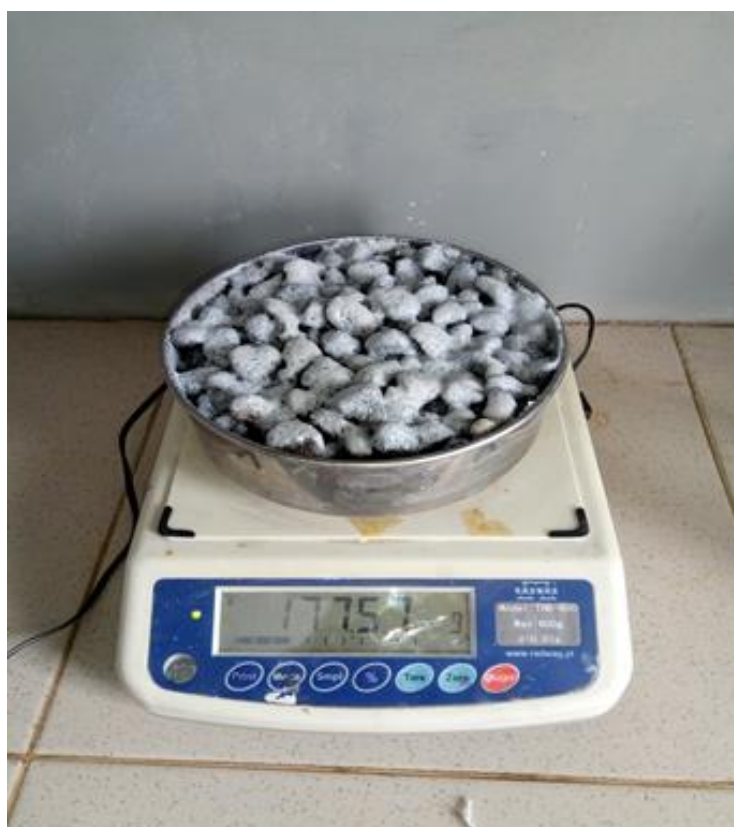
Рис.3.2 Зважування ємності з бензолом накритою сіткою і бінарним шаром піноскло+ гель
