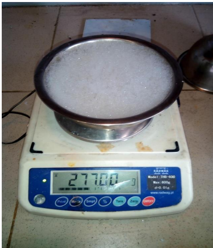
Рис 3.7 Ілюстрація повітряно-механічної піни на поверхні бензолу, на початку експерименту
