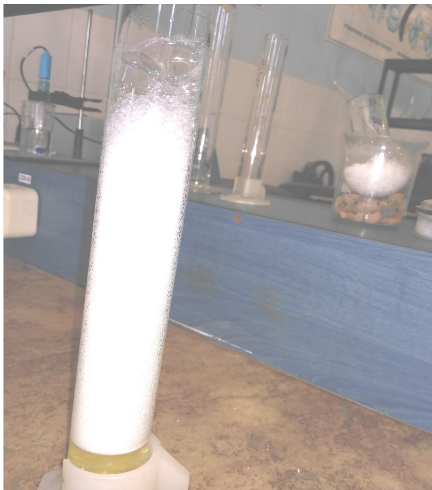
Рис.3.1 Дослідження кратності твердої піни
