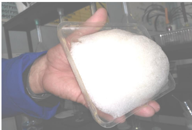
Рис.2.6 Ілюстрація швидкотвердіючої піни в нахиленому стані
