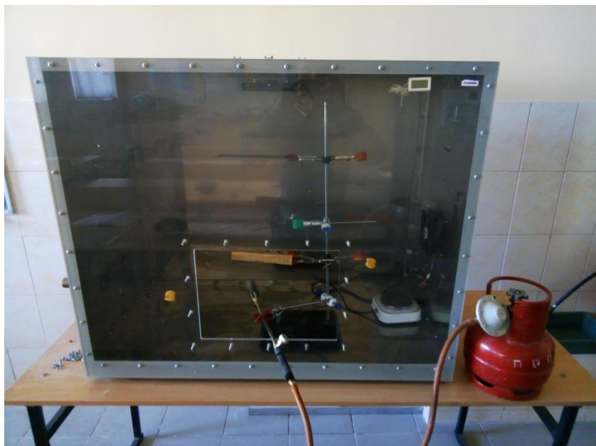
Рис. 7. Зовнішній вигляд лабораторної установки для дослідження поверхневих властивостей сажі та золи.
