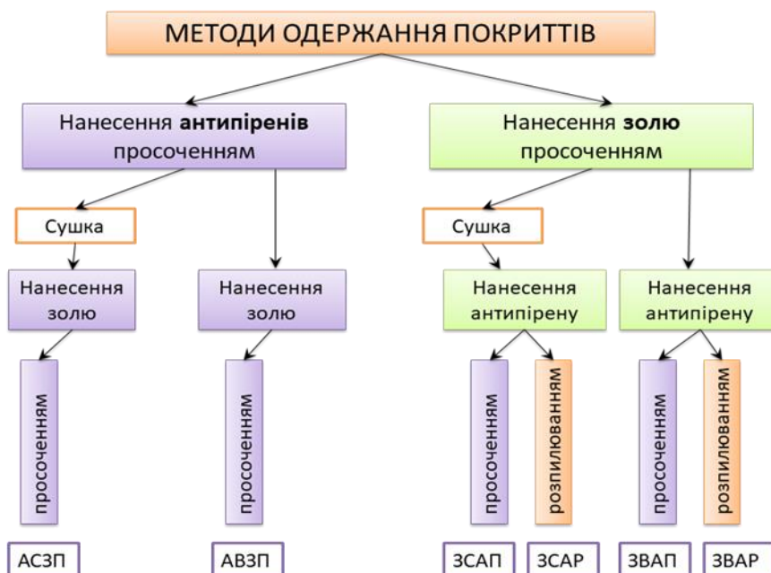
Рис.3.2.Методи нанесення покриттів та їх умовне позначення
