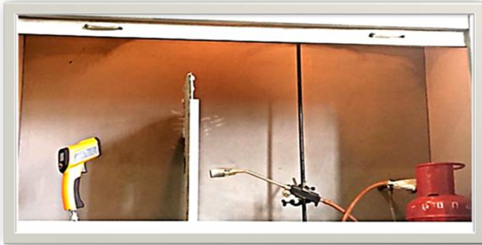
Рис.2.2. Лабораторна установка для випробувань просочених тканин на вогнестійкість
