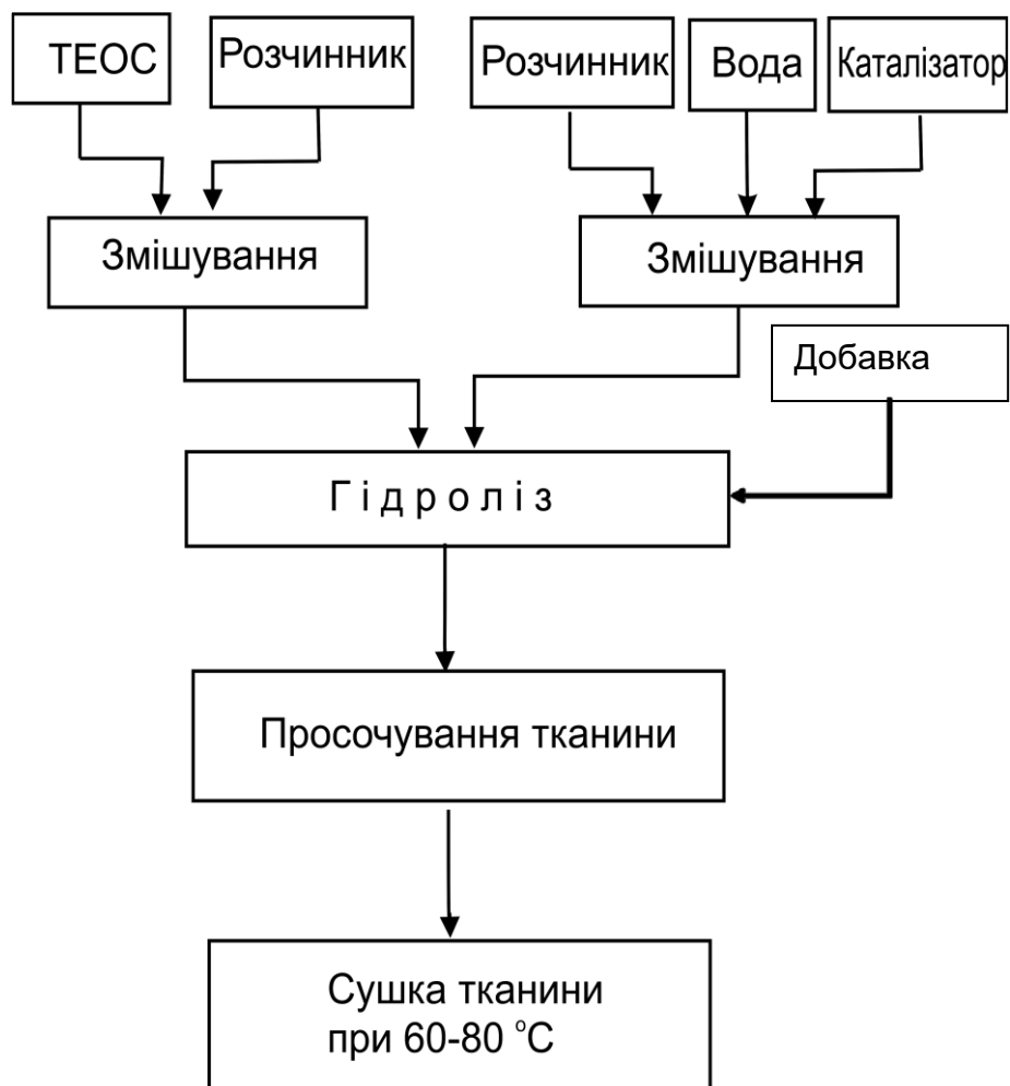
Рис.2.1. Схема одержання експериментальних покриттів по тканинах
