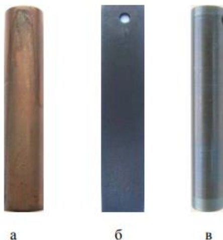
Рис.2.4 – Зовнішній вигляд зразків сталей 06X18H10T (а), 08X18H10T (б), 12X18H10T (в) після випробувань протягом 6000 год при температурі 350 ° С у воді з рН=7,2
