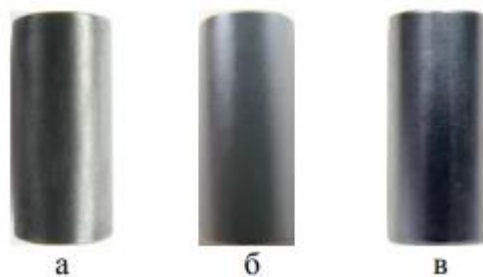
Рис.2.2 – Зовнішній вигляд поверхні труб-оболонок сплаву E110 після 6000 год корозійних випробувань при температурі 350 °C і тиску 16,5 МПа в середовищах з різними pH:
