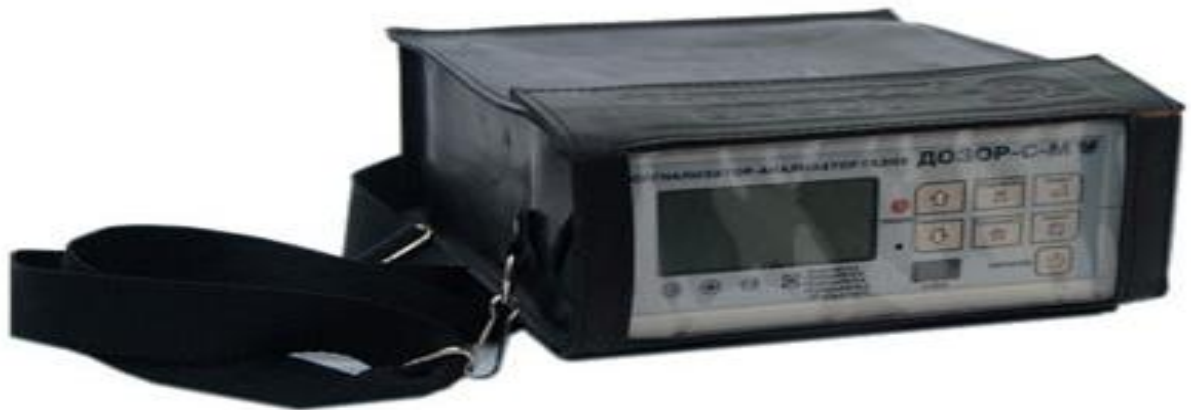
Рис. 2.2 – Переносний багатоконпонентний газоаналізатор "Дозор-С-М"
