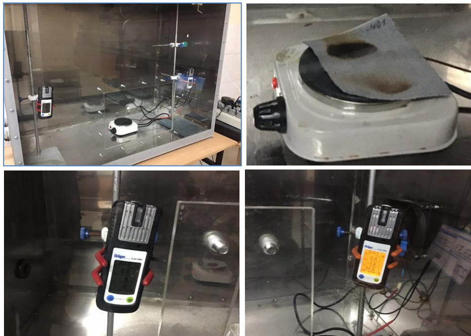
Рис. 2.3. – Лабораторна установка для визначення димо- та газоутворення під час нагрівання зразків текстильних матеріалів
