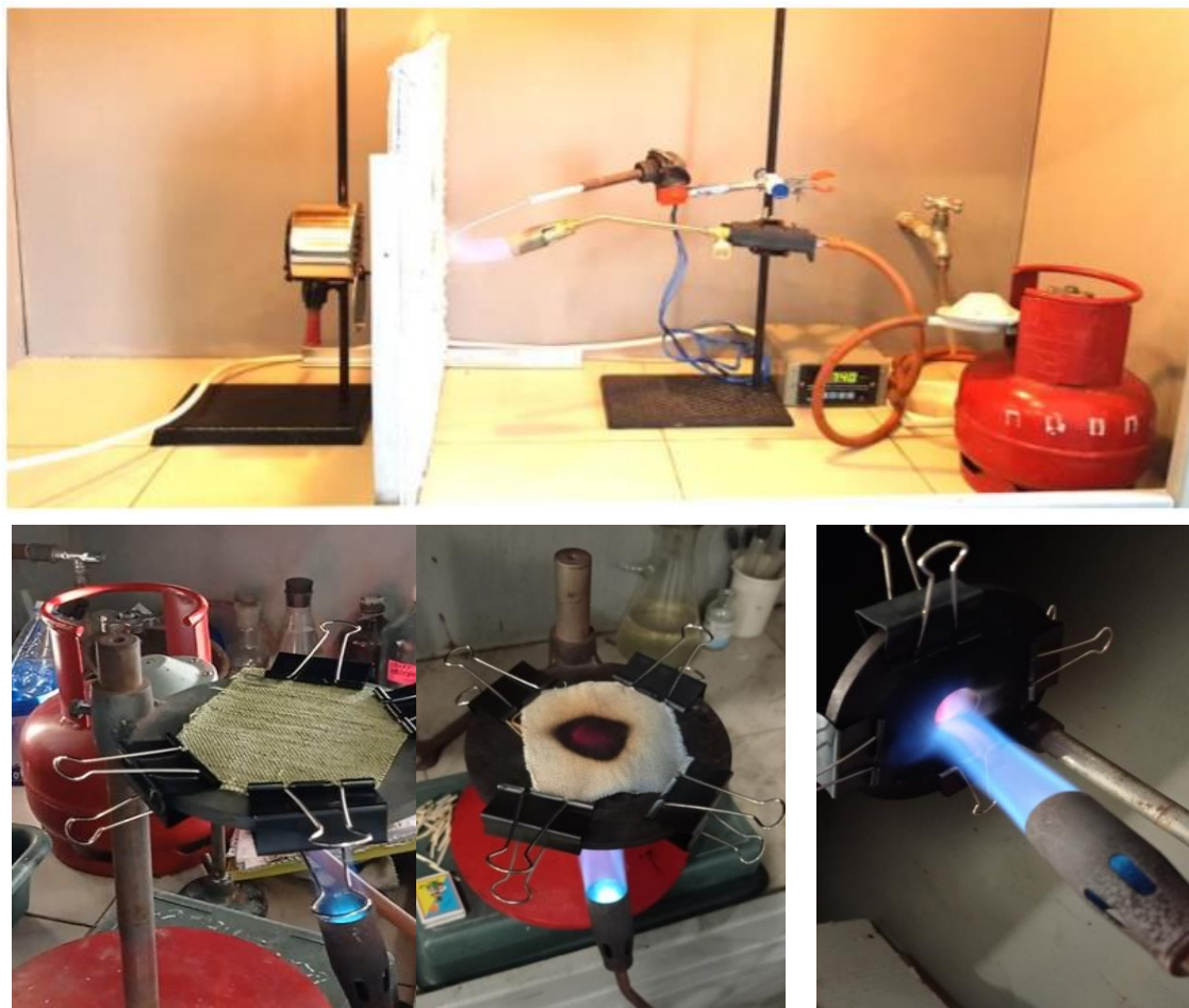
Рис.2.2. – Лабораторна установка для випробувань просочених тканин на вогнестійкість
