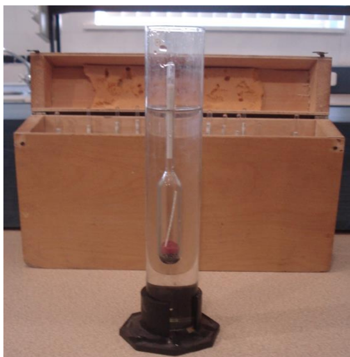
Рис. 2.1. Визначення густини розчинів за допомогою набору ареометрів АОН-1
