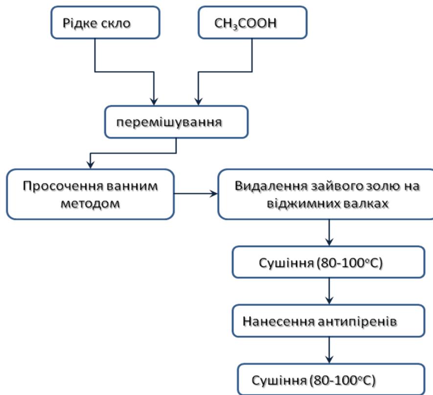
Рис.2.1 – Схема одержання експериментальних покриттів на основі рідкого скла
