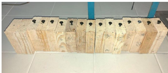
Рис.2.2 – Загальний вигляд зразків деревини з покриттям до вогневих випробувань
