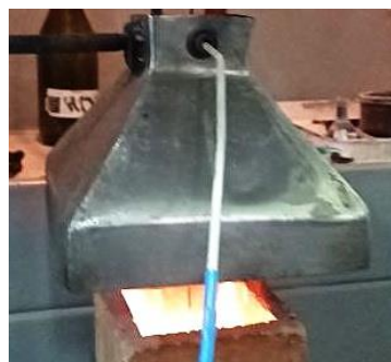
Рис.2.2 - Лабораторна установка з визначення вогнестійкості зразків деревин
