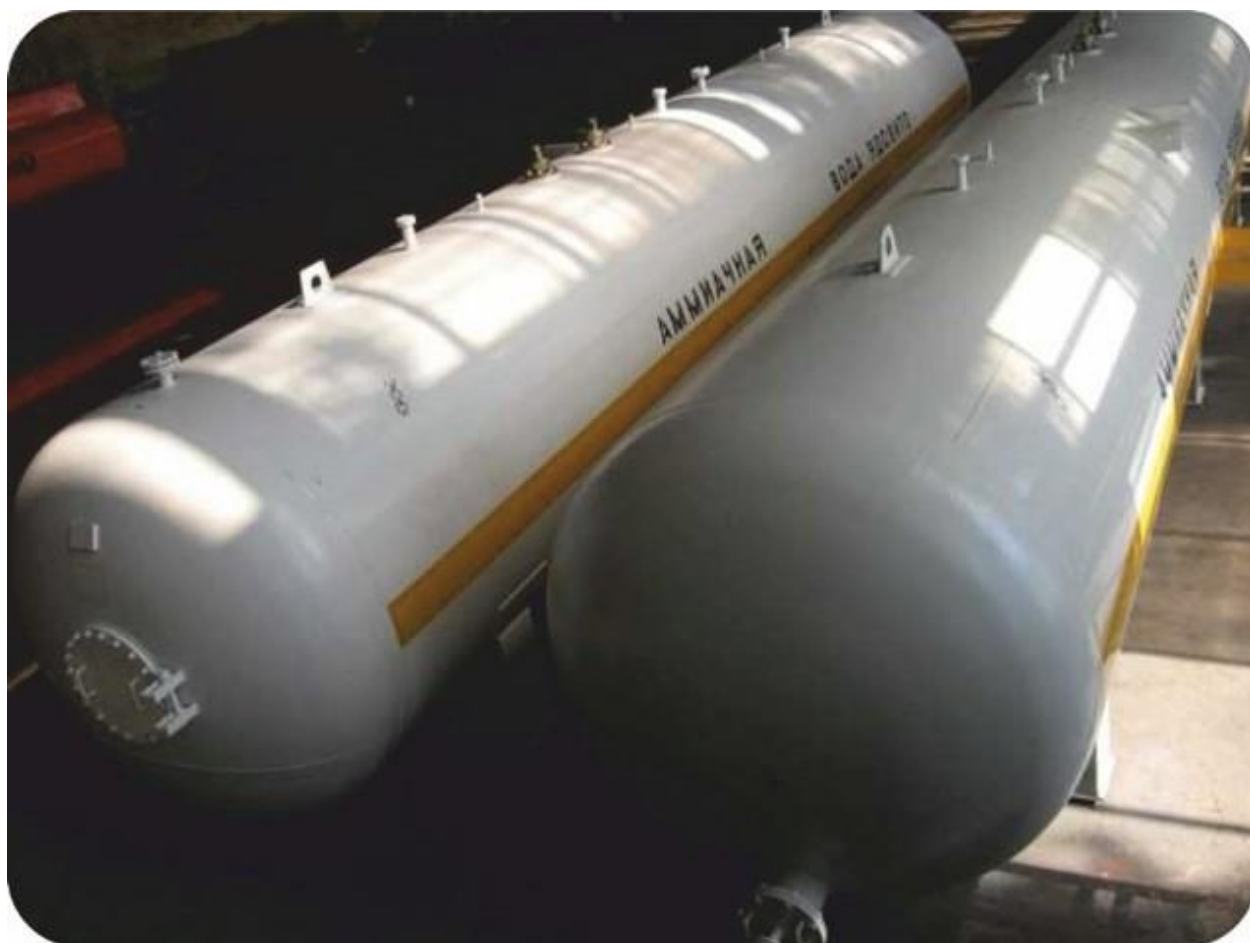
Рис. 1.4. Ємність для зберігання аміачної води об'ємом 75 м 3
