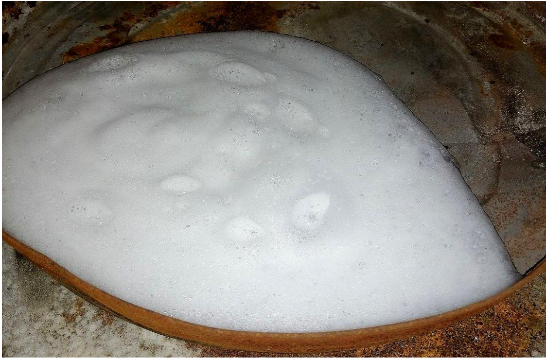
Рис. 3.8 Швидкотвердіюча піна \text{Na}_2\text{O} \cdot 2,5\text{SiO}_2 - 3 \% + (\text{NH}_4)_2\text{SO}_4 - 7.5 \%
