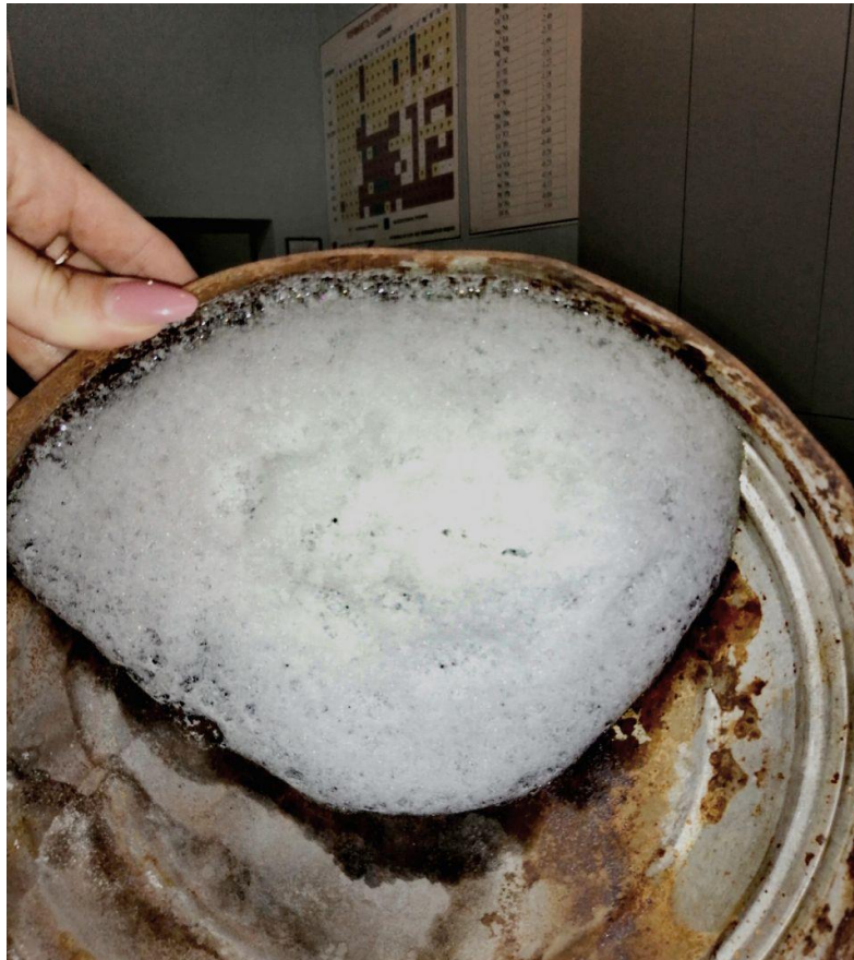
Рис. 3.8 Ілюстрація швидкотвердіючої піни \text{Na}_2\text{O} \cdot 2,5\text{SiO}_2 - 3\% + (\text{NH}_4)_2\text{SO}_4 - 7.5\% , через 24 години у вертикальному положенні
