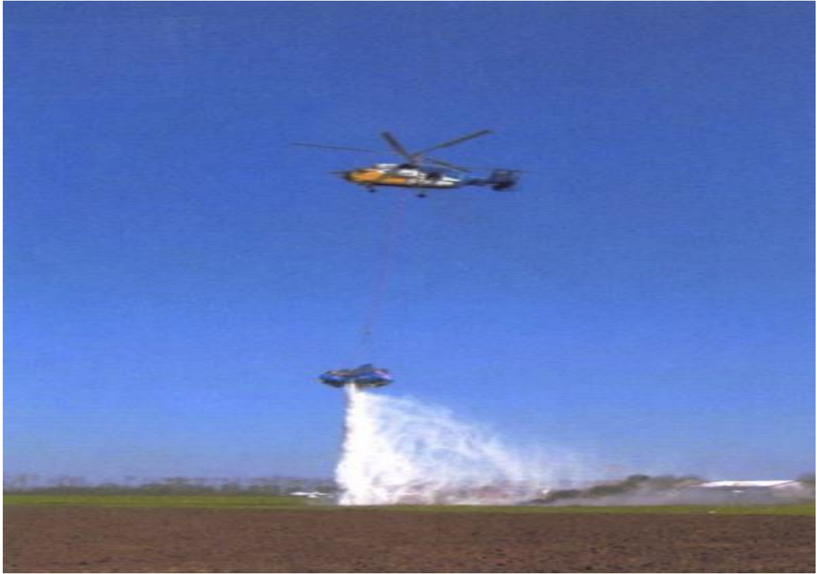
Рис. 4.7 Пристрій для гасіння пожеж швидкотвердіючою піною під час випробування
