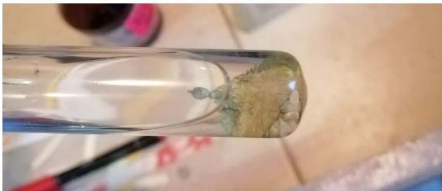
Рис.3.3 - Ртуть в лужному розчині гіпохлориту натрію
