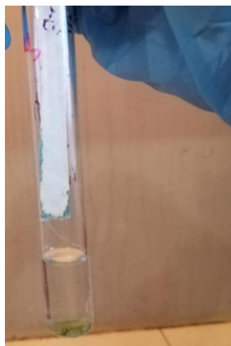
Рис. 3.7 - Визначення наявності парів ртуті індикаторним папером через дві години
