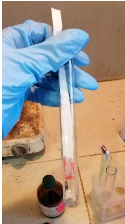
Рис. 3.4 - Визначення наявності парів ртуті індикаторним папером
