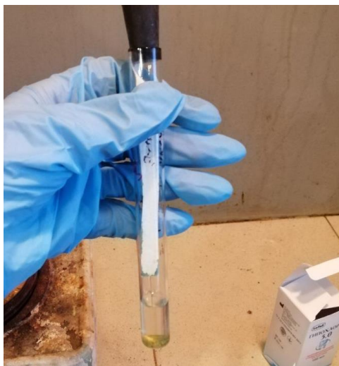
Рис. 3.7 - Визначення наявності парів ртуті індикаторним папером через 15 хв.
