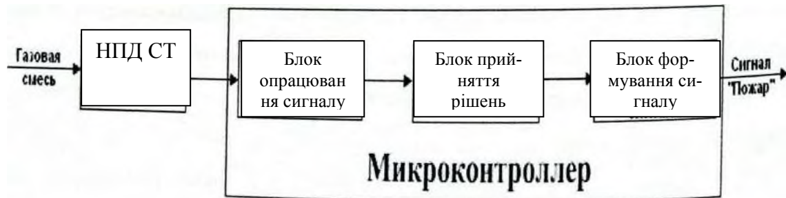
Рис. 1.19. Структурна схема ДПІ з НПД СТ
