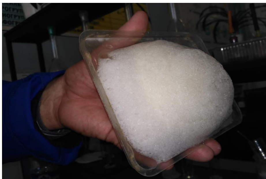
Рис.3.5. Ілюстрація швидкотвердіючої піни в нахиленому стані
