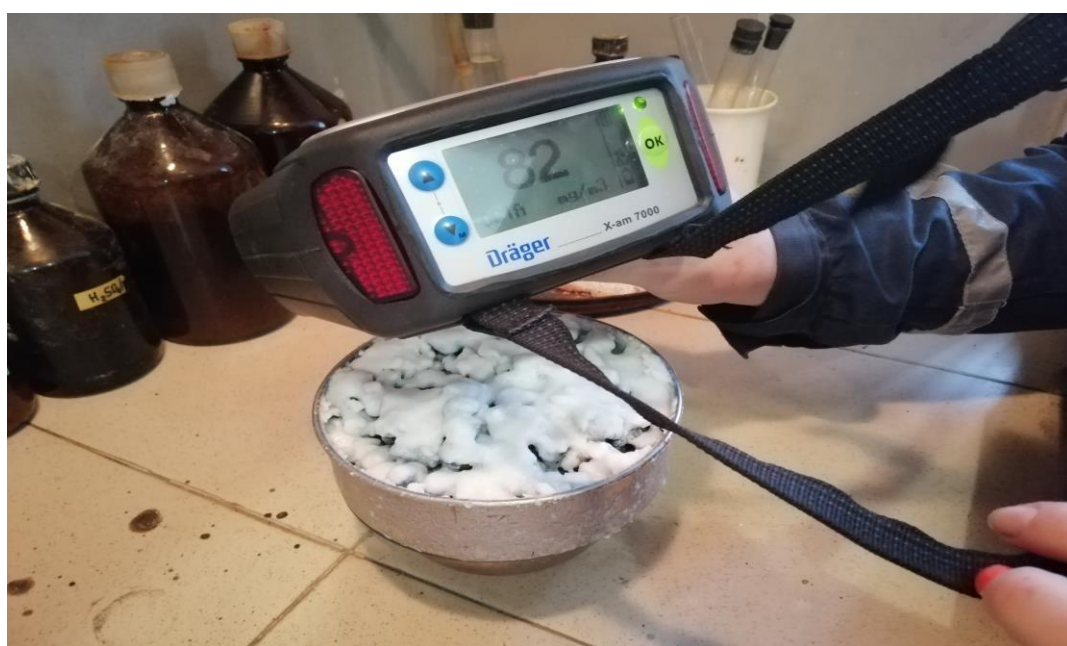
Рис.3.4.- Ілюстрація дослід з випарюванням швидкості випаровування бензену через бінарний шар піноскло - гель приладом Dräger 7000
