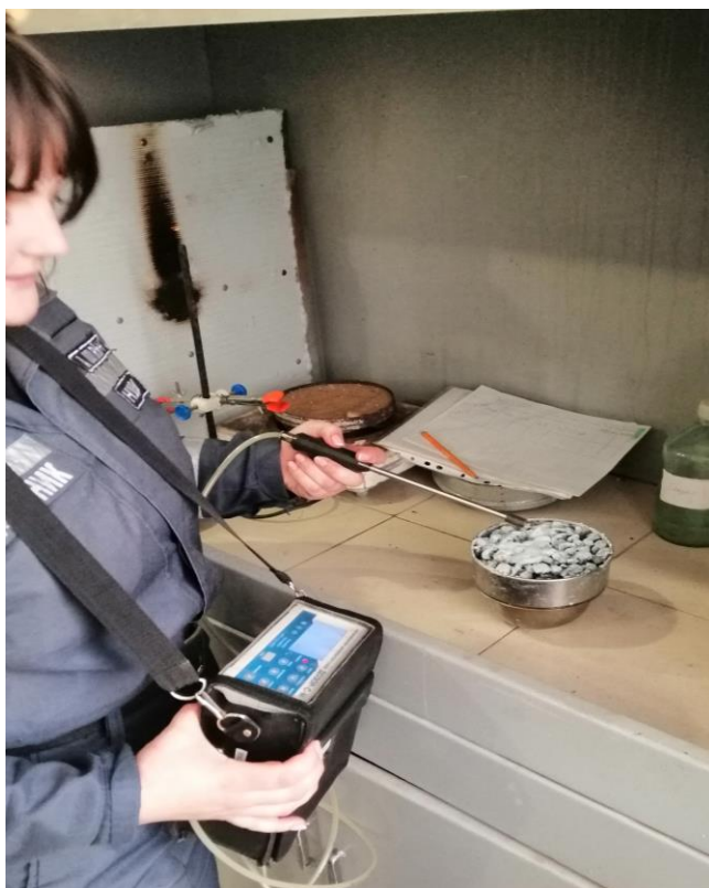
Рис.3.3.- Ілюстрація дослід з випарюванням швидкості випаровування бензену через бінарний шар піноскло - гель приладом ДОЗОР
