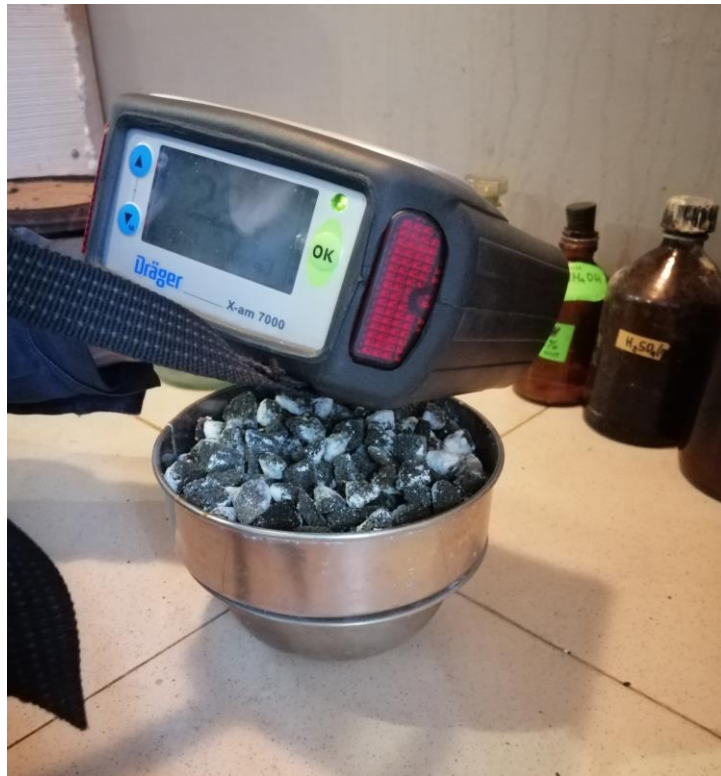
Рис.2.8.- Вимірювання швидкості випаровування приладом Dräger 7000
