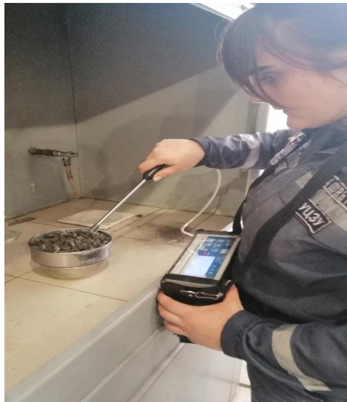
Рис.2.7.- Вимірювання швидкості випаровування бензену приладом ДОЗОР
