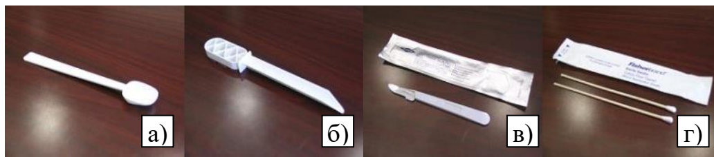
Рис. 1.6. Засоби для відбору твердих зразків (а - ложка, б - лопатка, в - скальпель, г - тампон)
