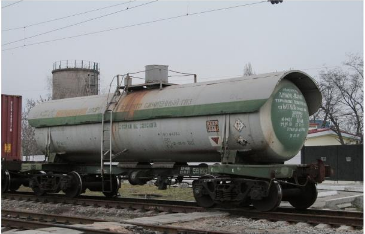
Рис 2.3. Зовнішній вигляд цистерни для хлора моделі 15-1556.
