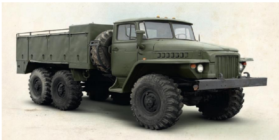
Рис. 2.8 Авторозливна станція АРС-15.
