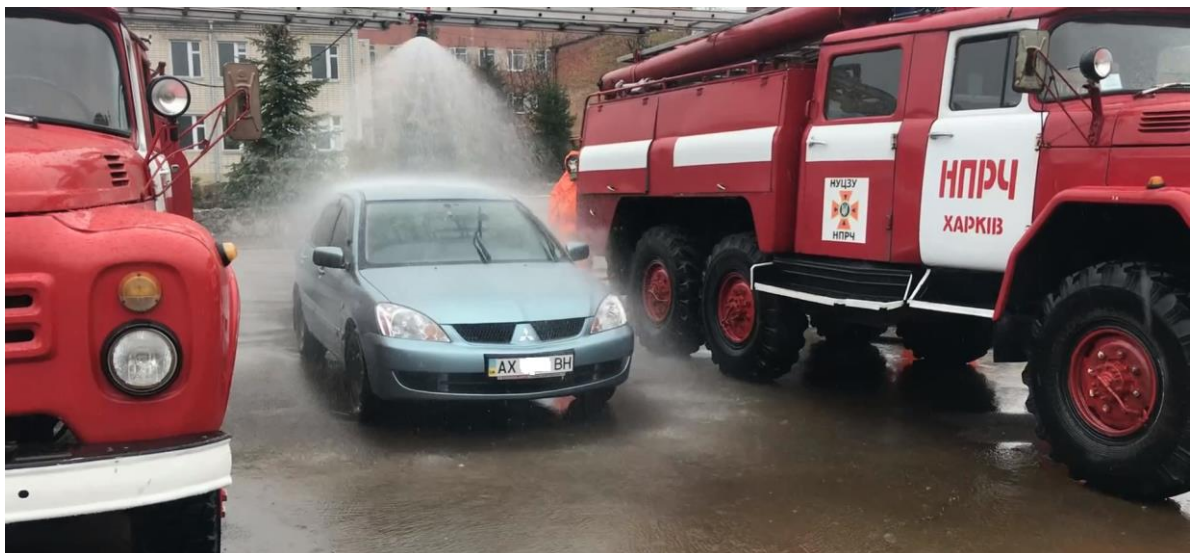
Рис. 4.5 Проведення деконтамінаційної (спеціальної) обробки техніки за допомогою пристрою для деконтамінації.
