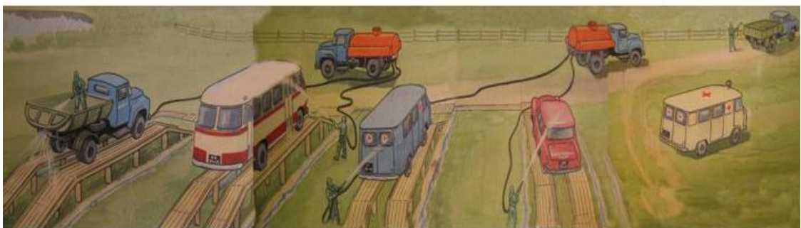
Рис. 2.7. Проведення спеціальної обробки транспорту із застосуванням поливо-мийних машин
