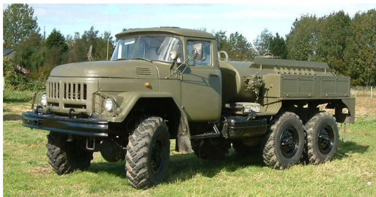
Рис. 2.14. Авторозливна станція АРС- 14
