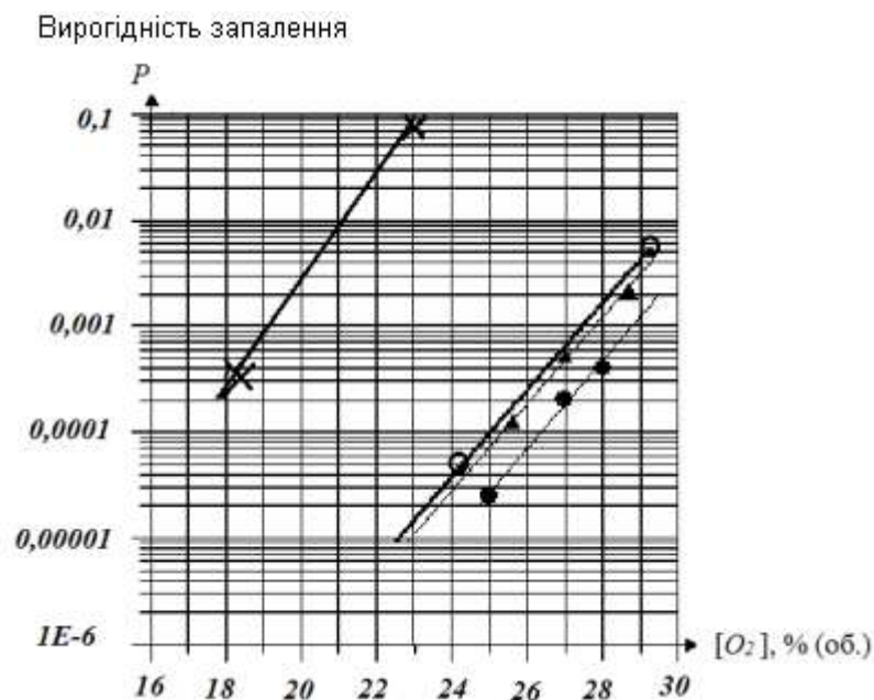
Рис 1.7 - Залежність запалює здатності фрикційних іскор від вмісту кисню в горючій суміші (12% (об.) H_2 ) і швидкості ковзання: ● - швидкість ковзання 23 м / с, пара тертя мідь-сталь; ▲ – швидкість ковзання 48 м / с, пара тертя мідь-сталь; □ - швидкість ковзання 70 м / с, пара тертя мідь-сталь; × - швидкість ковзання 70 м / с, пара тертя мідь-іржава сталь
