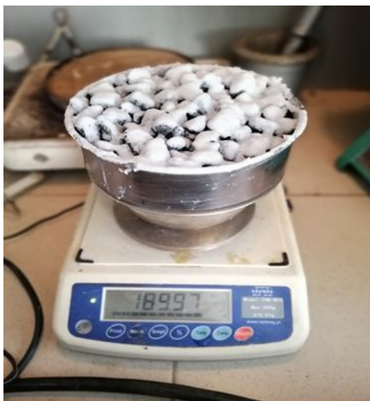
Рис.3.2.- Фото к дослідю з визначення ізолюючих властивостей шару піноскло - гель
