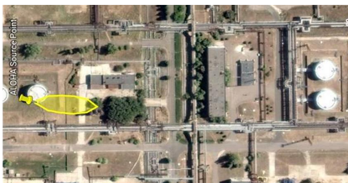
Рис.3.4. - Зона зараження токсичними парами бензолу з урахування коефіцієнту зменшення випаровування (K)
