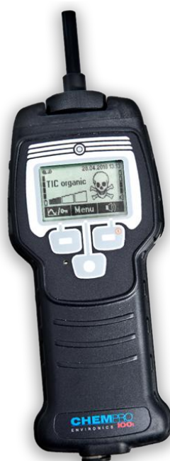
Рис. 1.4 - Портативний детектор газів ChemPro100i
