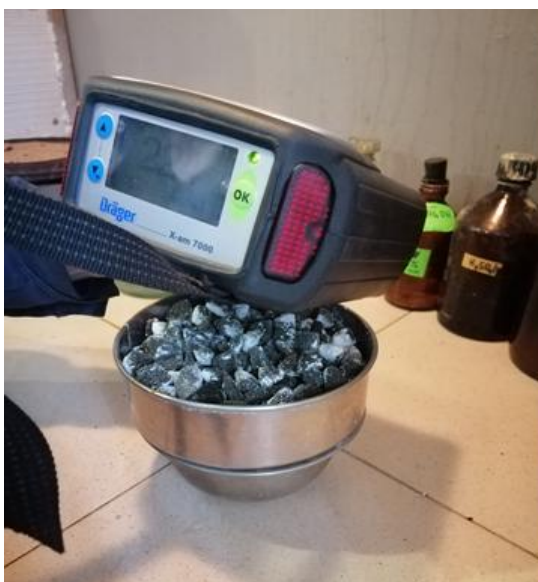
Рис.2.2.- Вимірювання концентрації рідини приладом Dräger 7000
