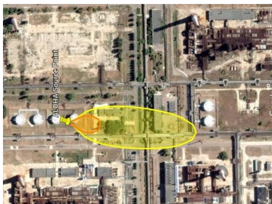
Рис.3.3. - Зона зараження токсичними парами бензолу без урахування коефіцієнту зменшення випаровування (K)
