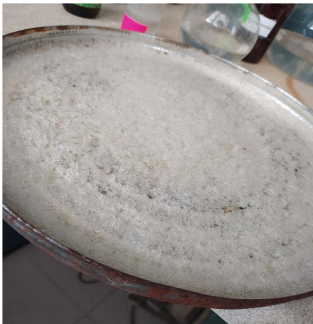
Рис.3.3 Ілюстрація виду швидкотвердіючої піни через 12 години
