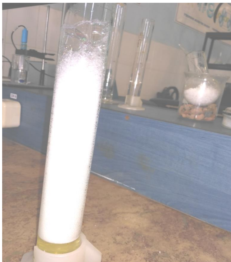
Рис.3.1 Дослідження кратності твердої піни
