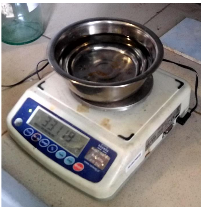
Рис.3.4 Дослідження випарування бензену з вільної поверхні
