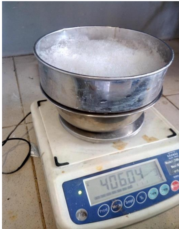
Рис.3.8 Дослідження випарування бензену крізь шар швидкотвердіючої піною на основі гелеутворюючої системи амоній хлорид + рідке скло, товщиною 4 см
