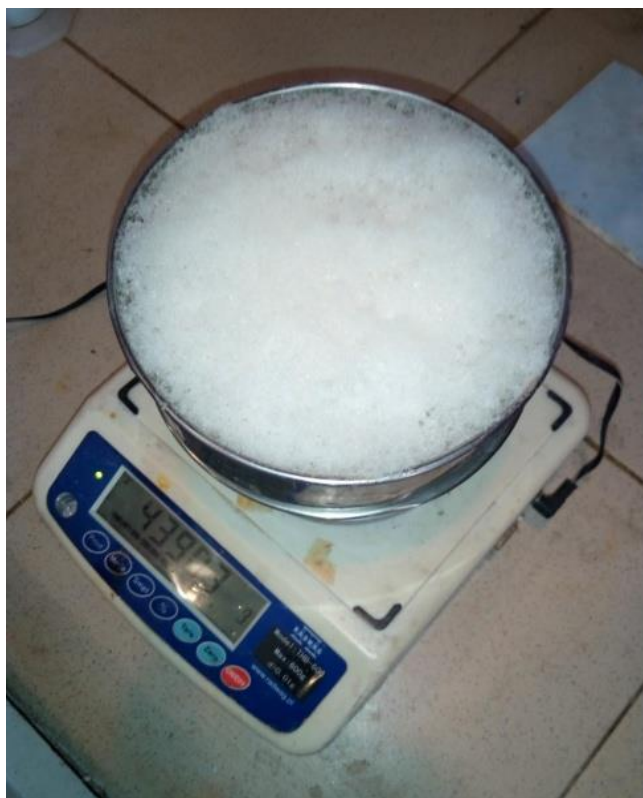
Рис.3.6 Дослідження швидкості випарування бензену крізь шар швидкоотвердіючої піною на основі гелеутворюючої системи дигідрофосфат натрія + рідке скло товщиною 4 см
