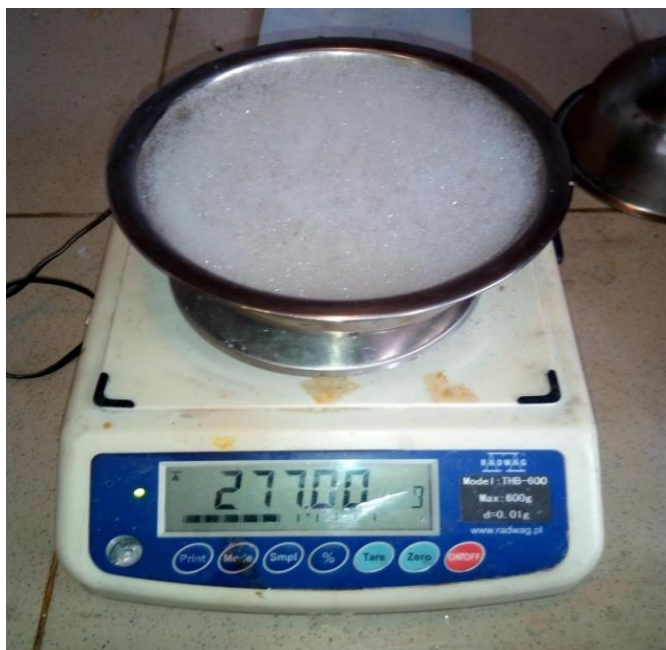
Рис.3.5 Дослідження швидкості випарування бензену крізь шар повітряно-механічної на початку експерименту
