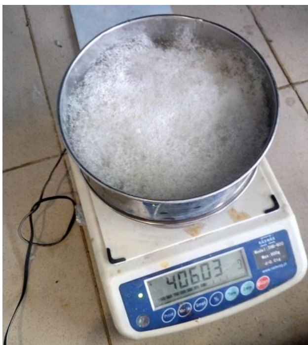
Рис.3.7 Дослідження швидкості випарування бензену крізь шар швидкотвердіючою піною, товщиною 2 см
