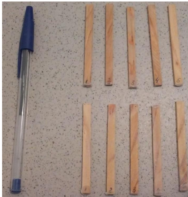
Рис. 2.3 – Зразки деревини, підготовлені для дослідження Згідно ГОСТ [55] КІ (% об.) Обчислюють за формулою:
