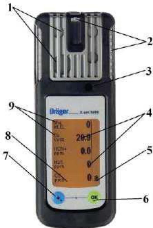
Рис. 1.6 – Загальний вигляд приладу Dräger X-am 5000: 1 – отвір надходження газу; 2 – сигнальний світлодіод; 3 – звуковий сигнальний пристрій; 4 – індикація виміряного значення; 5 – спеціальні символи; 6 – кнопка [ОК]; 7 – кнопка [+]; 8 – дисплей; 9 – індикація вимірюваного газу
