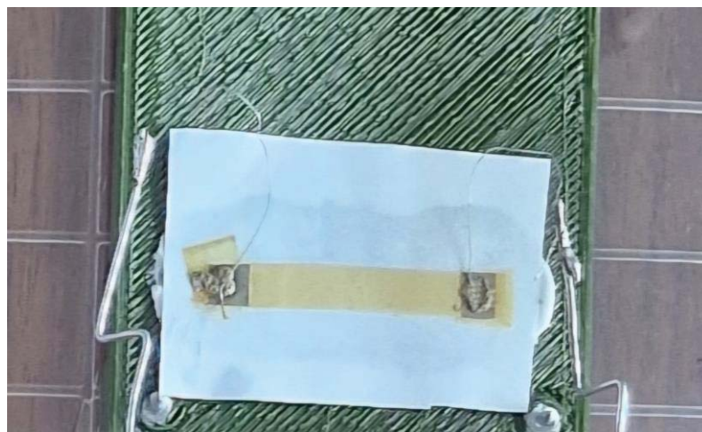
Рис. 2.8 – Фотографії плівки ZnO на підкладці PI, яку отримано за допомогою методу SILAR
