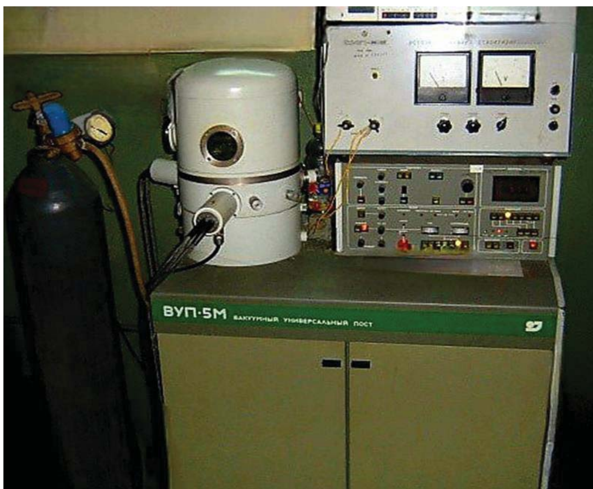
Рис. 2. 1 – Вид вакуумної установки ВУП-5М для отримання досліджуваних зразків газового сенсору на основі ZnO методом магнетронного розпилення на постійному струмі
