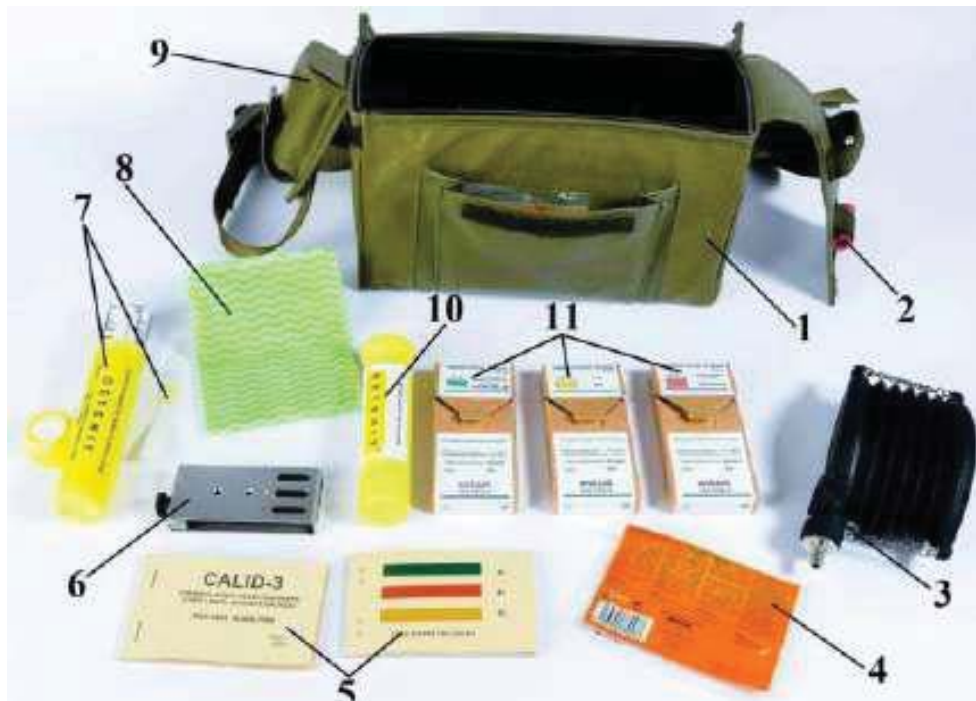
Рис. 1. 4 – Загальний вигляд військового комплекту хімічної розвідки: 1 – сумка; 2 – з'єднувальна трубка; 3 – ручний насос; 4 – зігріваючий пакет для індикаторних трубок; 5 – індикаторний папір для виявлення бойових отруйних речовин; 6 – пристрій для відкривання індикаторних трубок та ампул; 7 (10) – індикаторна стрічка для виявлення бойових отруйних речовин нервово-паралітичної дії; 8 – тканина для протирання; 9 – запасні частини для насоса; 11 – індикаторні трубки
