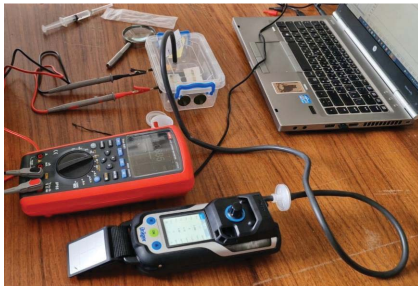
Рис. 2.10 – Загальний вигляд лабораторної установки для дослідження основних характеристик газового сенсору на основі ZnO
