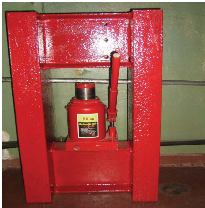
Рис. 2. 3 – Прес для формування цинкової мішені
