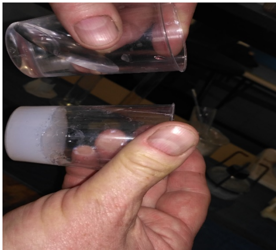
Рисунок 2.2. Визначення часу гелеутворення шляхом нахилу стаканчиків
