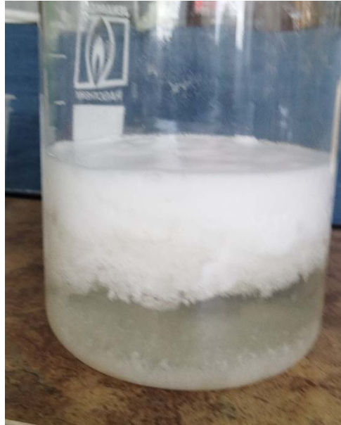
Рисунок 3.2 – Визначення плавучості твердої піни.
