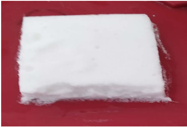
Рисунок 3.3. – Фрагмент затопленої ПШТ, який вилучено з ізопропанолу та поміщено на поверхню пластмаси
