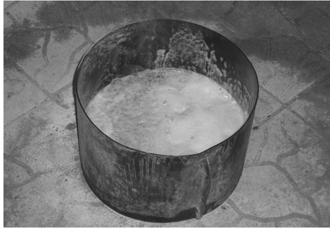
Рис. 3.1– Лабораторна установка для дослідження піноутворення на поверхні бензину
