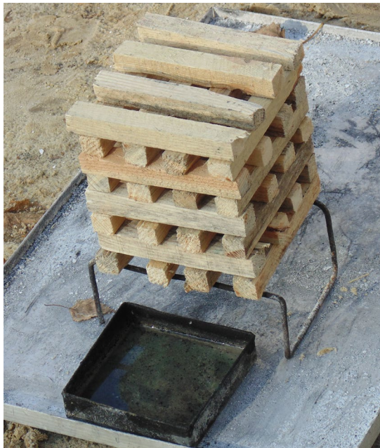
Рис. 4.1– Загальний вигляд модельного вогнища пожежі класу А
