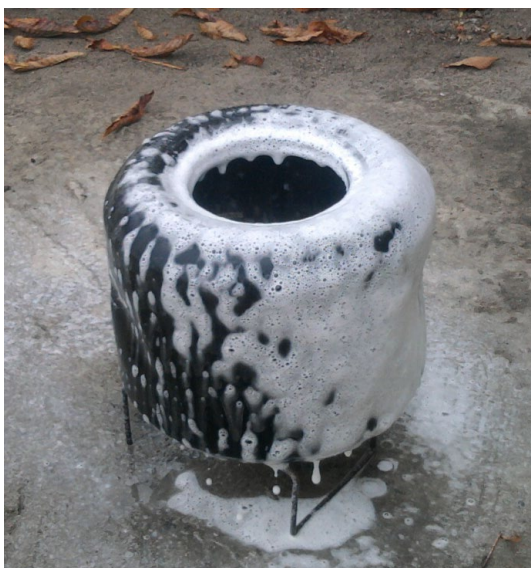
Рис. 2.1– Дослідження зтікання піни з поверхні гуми при використанні ПУС ( \text{NH}_4\text{H}_2\text{PO}_4 + \text{NaHCO}_3 + \text{ПУ «Морской»-6\% )
