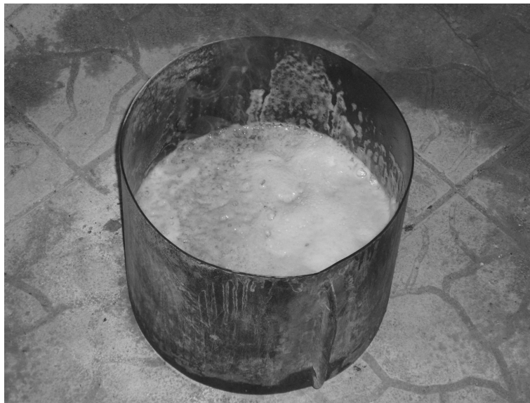
Рис. 4.5– Піна, що утворилася на поверхні бензину після припинення горіння
