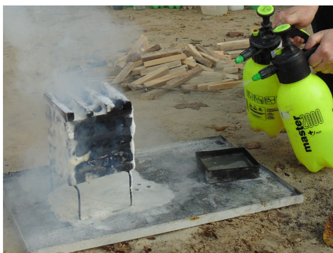
Рис. 4.3– Гасіння модельного вогнища пожежі класу А
