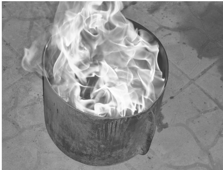
Рис. 4.4 – Горіння горючої рідини в модельному вогнищі 2В
