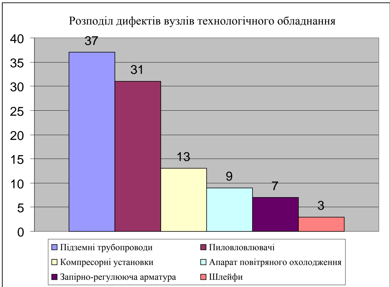
Рис 2.5 – Розподіл дефектів вузлів технологічного обладнання за даними джерела [5]
