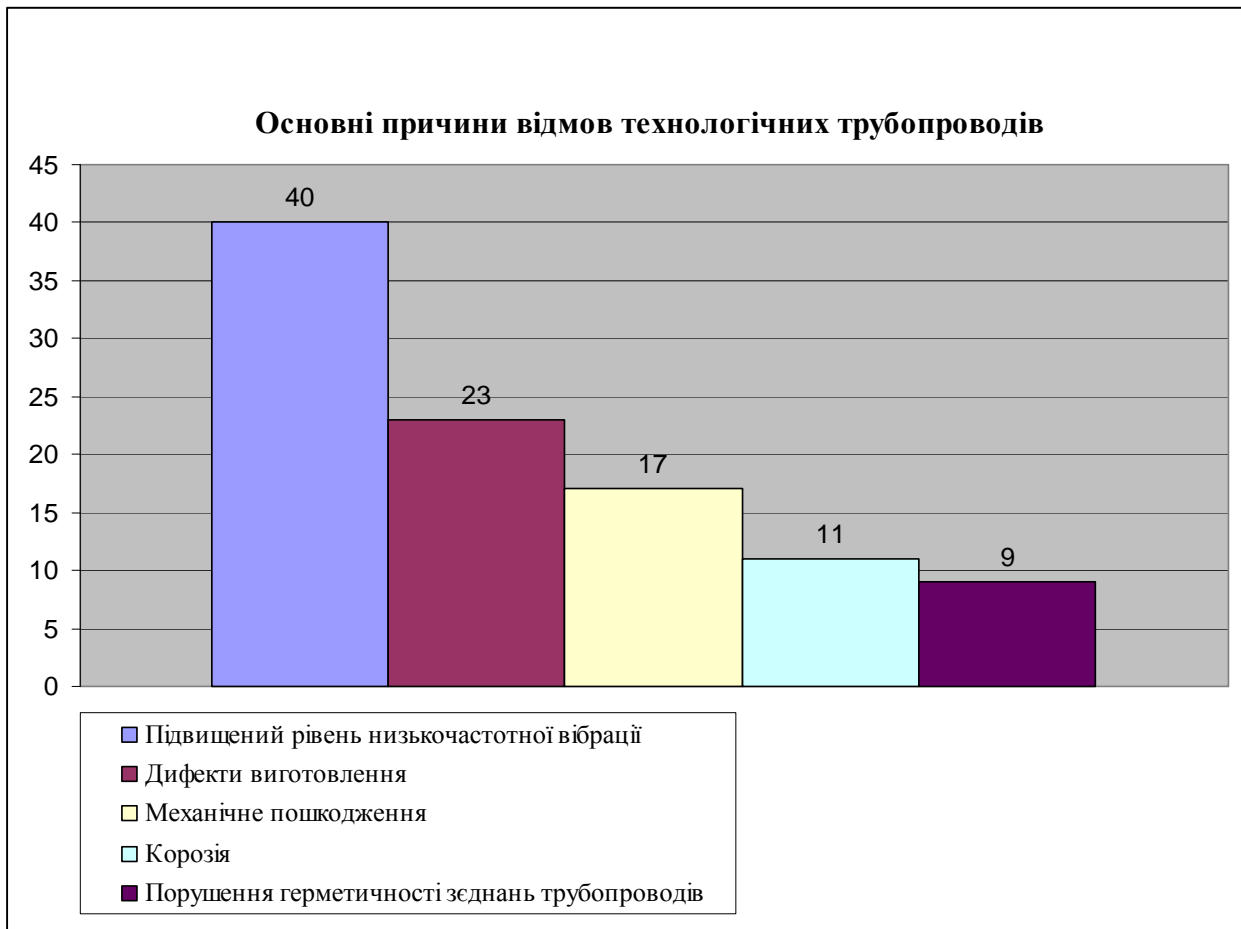
Рис 2.6. Основні причини відмов технологічних трубопроводів за даними джерела [5]
