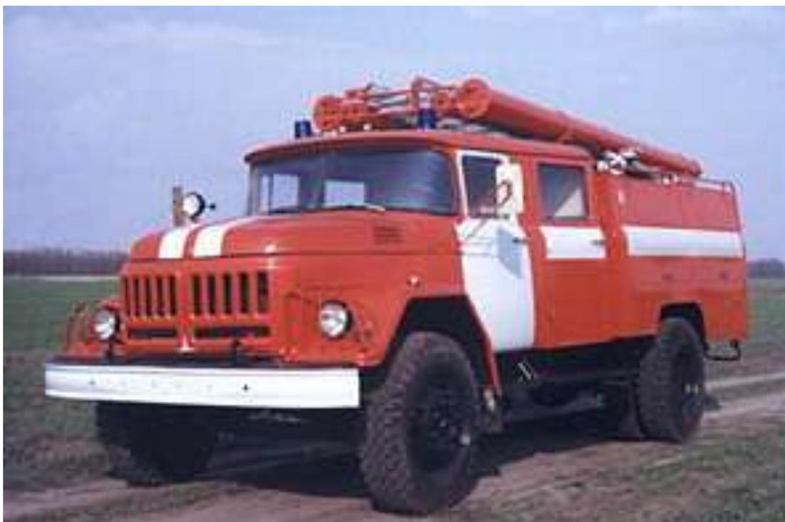
Автоцистерна пожежна АЦ-40(130) модель 63Б призначена для доставки до місця пожежі бойового розрахунку, засобів пожежегасіння, пожежно-технічного обладнання (ПТО) та слугує для гасіння пожежі водою та повітряно-механічною піною
