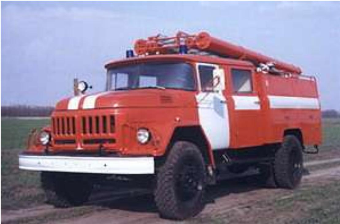
Автоцистерна пожежна АЦ-40(130) модель 63Б призначена для доставки до місця пожежі оперативного розрахунку, засобів пожежегасіння, пожежно-технічного обладнання (ПТО) та слугує для гасіння пожежі водою та повітряно-механічною піною
